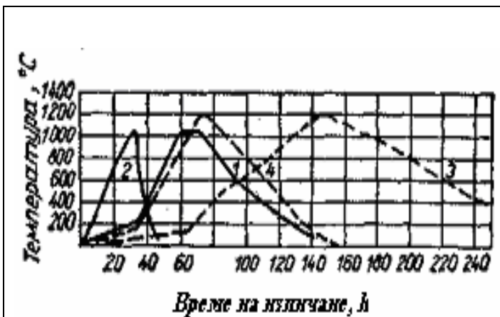
Фиг. 1.2. Температурен режим на изпичане в зависимост от типа на пещта и вида на керамичните изделия [11] 1 - тухли в полски пещи; 2 - тухли в тунелни пещи; 3 и 4 - огнеупорни изделия в периодична пещ
