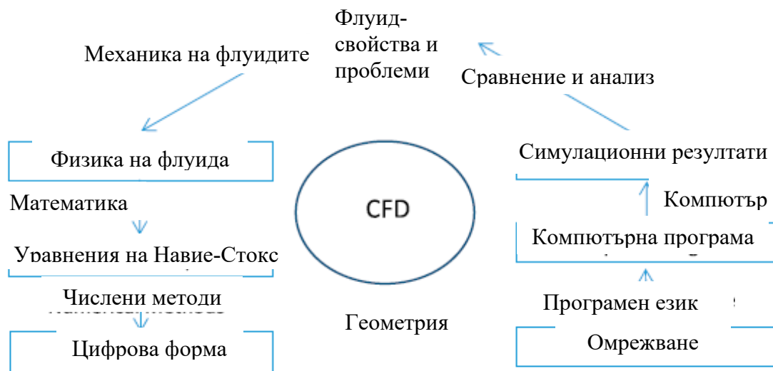
Фиг. 14. Схематично представяне на CFD процеса [16]
