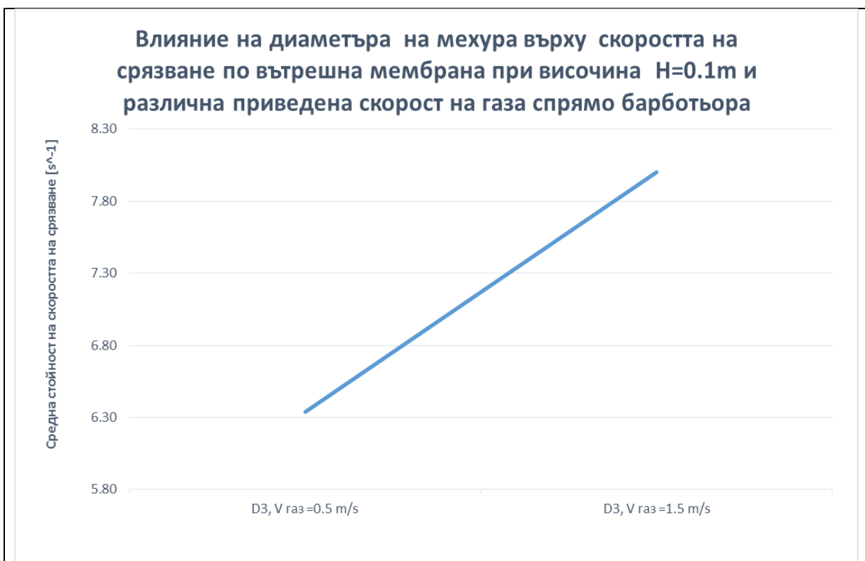
Фиг.47 Влияние на диаметра на мехура върху скоростта на срязване по вътрешната мембрана при различна приведена скорост.
