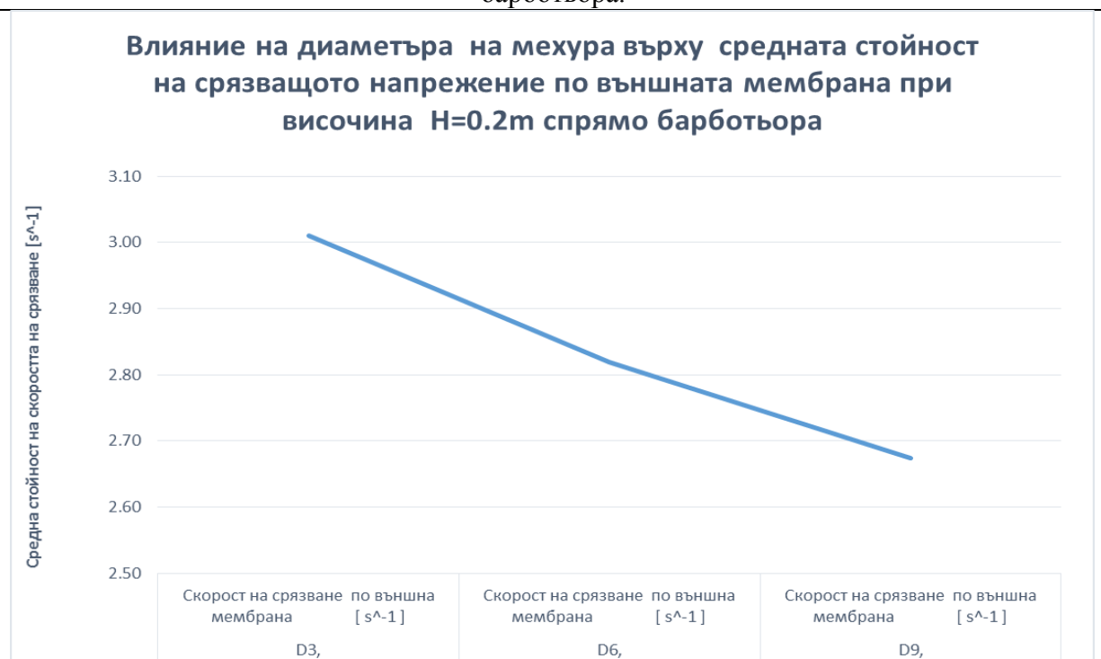
Фиг.32 Влияние на диаметъра на мехурите на газова фаза по дължина на външната мембрана при разстояние по височина на мембрания модул H=0.2\text{m} спрямо барботьора.
