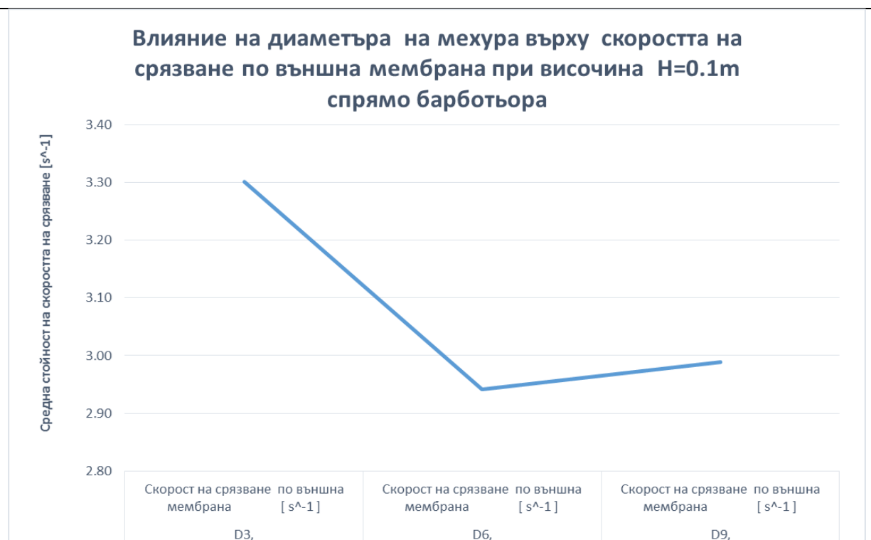
Фиг.31 Влияние на диаметъра на мехурите на газова фаза по дължина на външната мембрана при разстояние по височина на мембрания модул H=0.1\text{m} спрямо барботьора.
